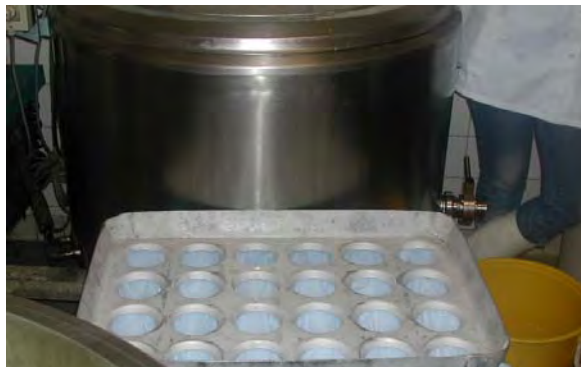
Répartiteur de caillé pour les moules à fromage
